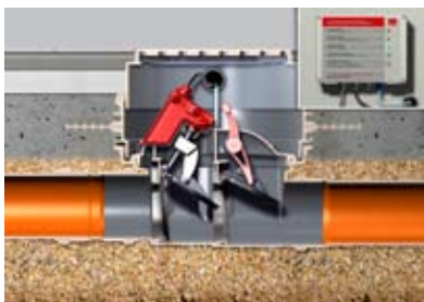
Figur 3. Quatrix är klar för drift. Bägge ventilkläffarna är öppna.
