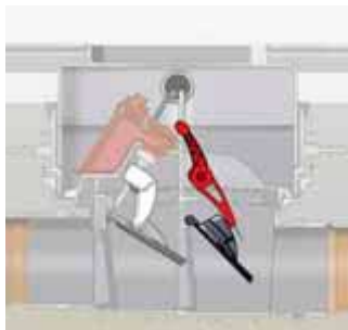
Figur 7. När klaffen skall stängas måste den först låsas upp från öppen position. Ett klickande ljud skall höras.
