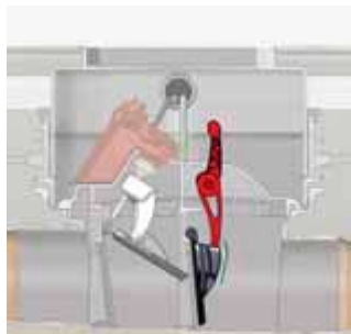
Figur 9. När klaffen öppnas skall ett klickande ljud höras. Det betyder att den har fångats upp av handtaget och öppnats.
