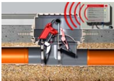
Figur 4. Bakvattentryck! Trycksensorn känner tryckförändringen i ledningen och stänger den motordrivna ventilkläffen. Samtidigt avges optisk och akustisk signal.
