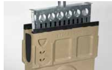
ACO Powerdrain V 75 P ränna med löv-/sandfångare i förzinkat stål, förtagning för anslutning och integrerad läppring (med anslutning 110 eller 160)
